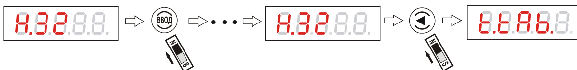
Рисунок 64 - Запись в память урвнемера 32 точек тарифовочной таблицы
