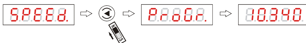
Рисунок 85 - Запись в память уровнемера введенных установочных параметров
