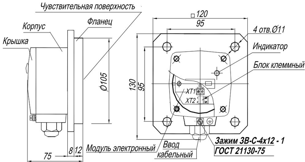
Рисунок В.1 – Внешний вид и габаритные размеры датчика
