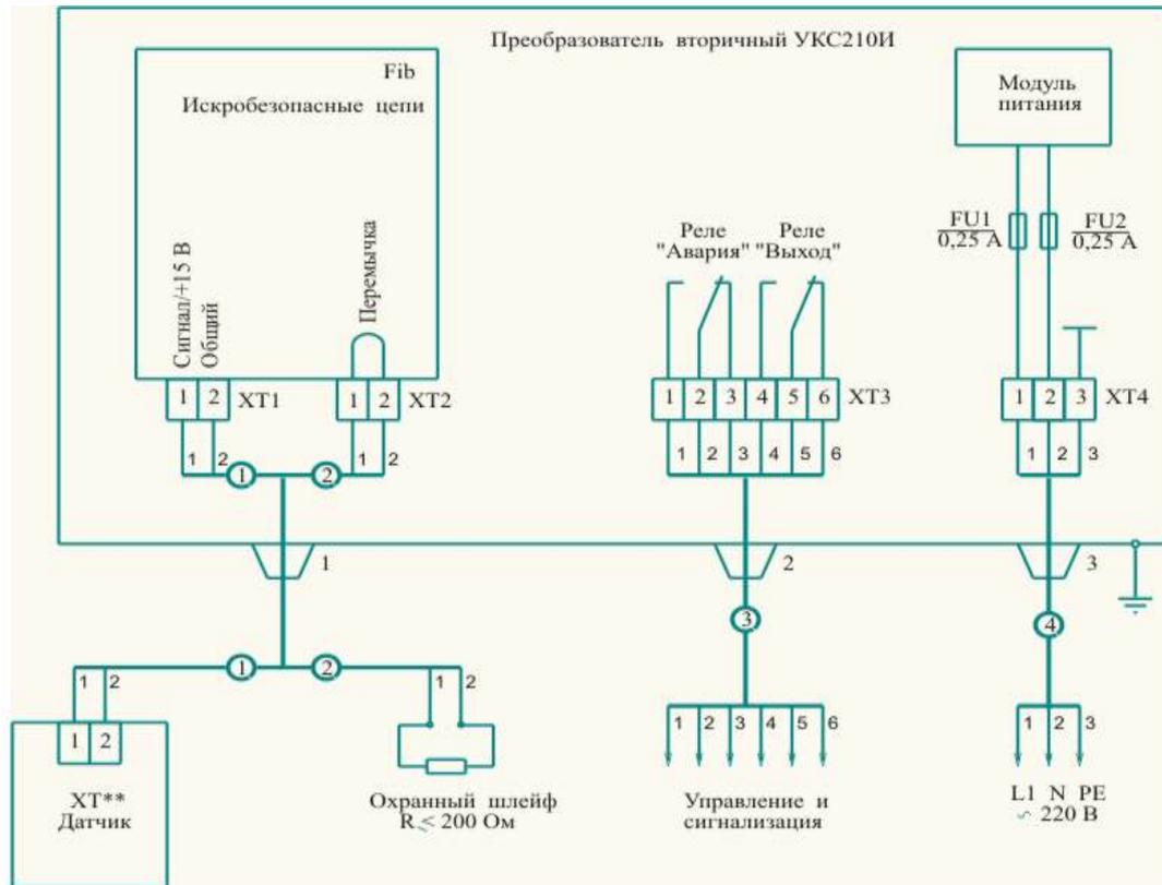
\* При использовании охранного шлейфа перемычку на соединителе XT2 вторичного преобразователя снять.
