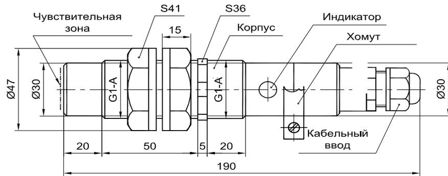
Рисунок Б.1 - Внешний вид и габаритные размеры датчика
